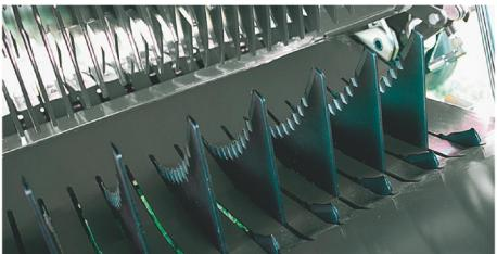
ナイフパンクを備えたカッティング装置を標準装備。13枚・17枚・25枚のナイフを備えた型式をご用意しました。ナイフの出し入れ操作はE-リンクプロコントロールからの操作で、ナイフ数を選択可能。作物に合わせて最適な切断長を選べます。
