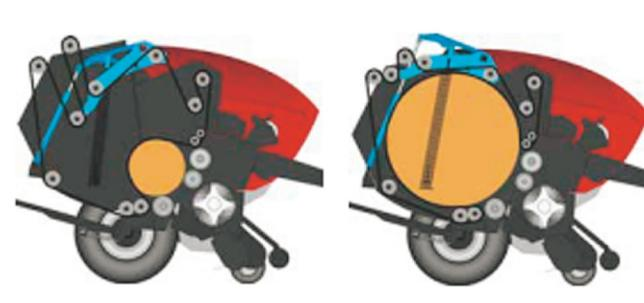
美しい形状と最適な密度を備えたベールを生み出す鍵は、ロールベーラーのチャンバー（ベール室）にあります。RP160Vは、イセキウェルガー伝統のバリアブル・チャンバーシステムを搭載。ベールはチャンバーの中心で形成され、密度は油圧シリンダーにより最適に保たれる為、ベールが美しい真円に仕上がります。ベール径はキャビン内のコントローラーから自在に変更可能です。
