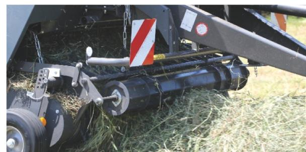
クロップ・プレスローラーは、スワースの大小にかかわらず、作物をピックアップ全域に渡り均一に広げる役割を持っています。作物の量が少ない場合は、ローラーの回転により作物を左右に広げます。作物の量が多い場合は、スワース全体にローラーを押し付ける事で、塊を作ることなく作物をスムーズにチャンバー内部へ導きます。スムーズな作物の流れは美しいベール形状につながります。
