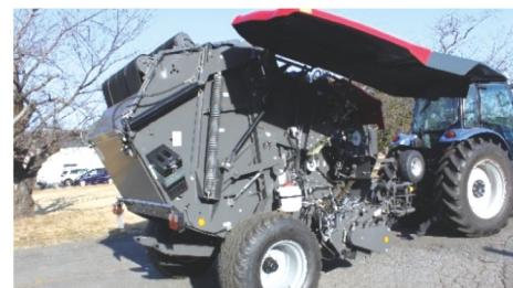
サイドカバーは上方向に開閉します。内部に配置された予備ネットの取り出しが容易になったのはもちろんの事、メンテナンス時の機械部品へのアクセス性も向上しました。
