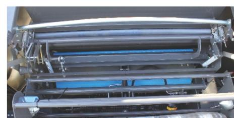
ベール形状にもこだわったネット結束システムを採用。カーブを描くように配置されたスプレッディング・チューブにより、ベールのエッジまでスムーズにネットを広げ、美しく包み込みます。効果的な結束は作業効率に大きく影響します。
