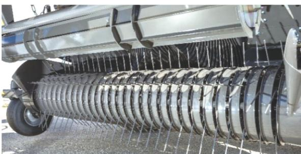
作物のピックアップ効率を最大限に高める為、カムレス・ピックアップを採用。長く、しなやかに設計されたタインは、耐久性に富み、あらゆる条件下で最もきれいに作物を集められる角度に調整されています。ピックアップユニット自体が従来よりコンパクトになり、ベーラー内のメインローラーにより近く配置されています。これによりスムーズな作物の流れを生み出します。
