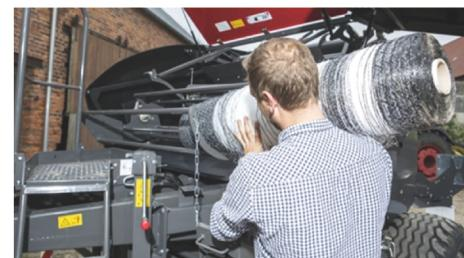
ネットの装填や、予備ネットの搭載はベーラーの側方から簡単に行えます。幅が1230～1300mmのネットを使用することが可能で、ネット固定はハンドル操作で簡単に行えます。
