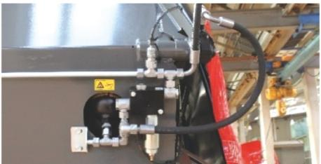
ベール密度は、独立回路の油圧シリンダーにより制御されます。油圧バルブの絞りを変える事によりベルトテンションにかかる圧力を変化させ、ベール密度を調整しています。この操作はコントローラーから行なう事が出来ます。
