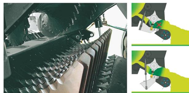
作業効率を左右するピックアップ部には、イセキウェルガー独自のシステムが搭載されています。草の量が多い時にはダンパーが動き、ボトムフレートが下がるので多くの牧草がチャンバーへ流れるようになります。(フレックスシステム)牧草が詰まった時には、油圧操作によりボトムフレートを完全に下げる事ができます。キャビンから降りる事なく詰まりを取り除き、安全に作業を続行する事が出来ます。
