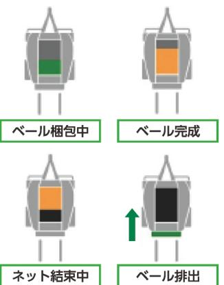
ロールベーラーの全機能は、ISOBUS対応した最新鋭のコントローラー、“Eリンクプロコントロール”により制御されます。グラフィカルに表示される画面により、作業状況を容易に把握可能です。7インチタッチスクリーンとボタンを兼ね備え、直感的に操作できます。さらにオプションの新機能：TIM・モイスチャーセンサー・重量計が追加されました。ベールを形成する作物の特性に合わせた最適な梱包圧を端末からの操作で切り替え可能です。ユーザー毎にベール個数を管理したり、園場毎に名前をつけて管理することも可能になりました。データをUSBポートを介してコンピュータへ保存することも可能です。
