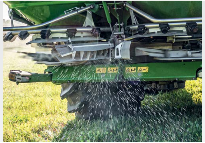
ZA-TSのボーダーTSディフレクターが作動すると、収納状態から散布ファンの位置まで旋回。特殊なバッフルプレート構造と無段階調節ガイドプレートで粒剤を優しく地面に誘導する
