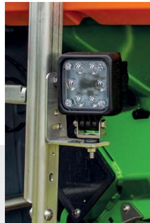
作業灯が点滅した時、設定した充填量に達したことを示します
