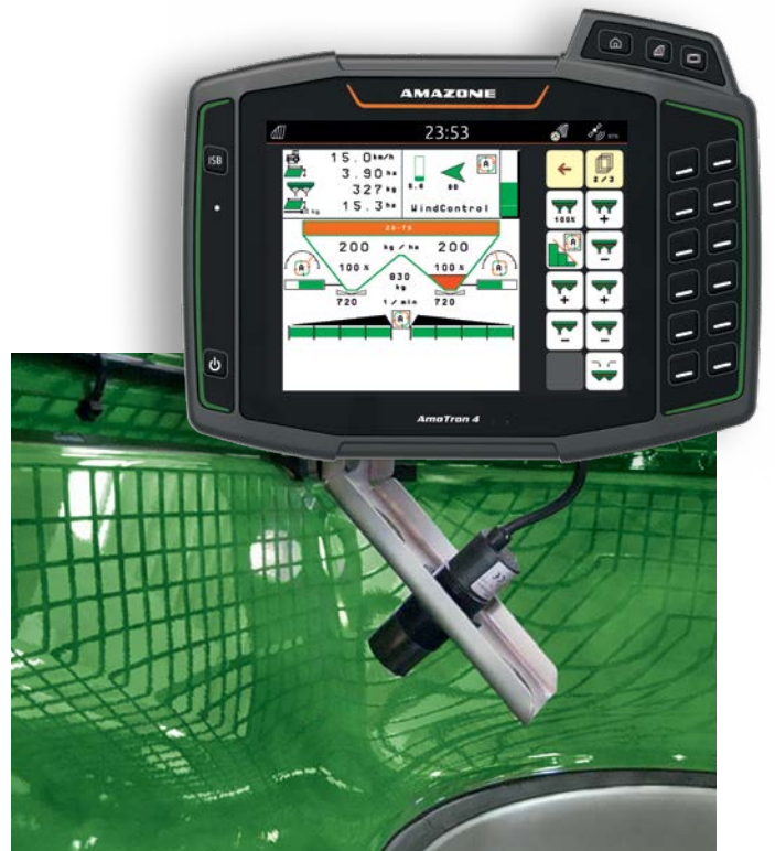
④ ZA-TS 残量センサー ホッパー先端のどちらかが空になりそうになると、オペレーターに早めに知らせます。
