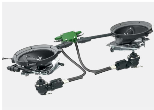
✔ ZA-TSハイドロ - 油圧式ディスク駆動
