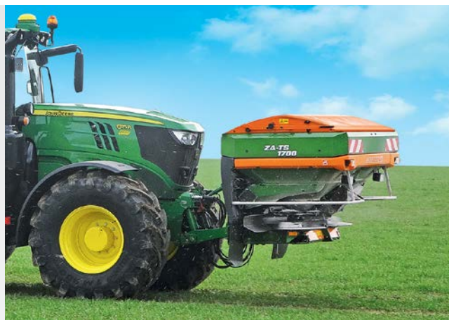
公道走行に適したライトキットを装備したフロント取付けブロードキャスター
