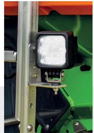
作業灯が点滅した時、設定した充填量に達したことを示します
