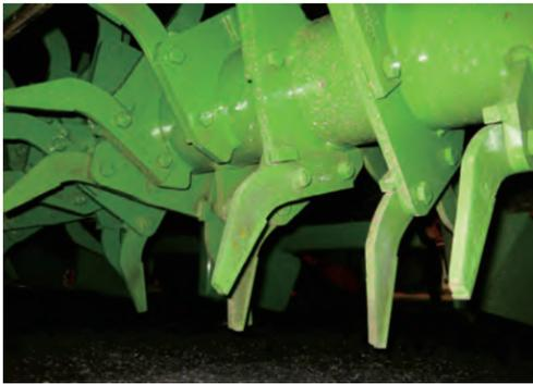
フックタイン式全面ロータリーセクションが330rpmで回転し、作業幅全体にわたり均一な碎土をもたらし、播種床、培土に最適なコンディションを用意します。碎土を適切に行なうことにより、土中の土塊が少なくなります。そのため収穫作業の効率化にも繋がります。
