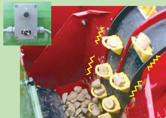
特に小粒の種イモや、カットした種イモを植付する際には、プランティングユニットのカップが、種イモを2個以上同時に拾い上げることがあります。これを落とすために、プランティング部に振動を与える、電動式バイブレーターを備えています。バイブレーターの強度とON・OFFはトラクターキャビン内から行なえます。
