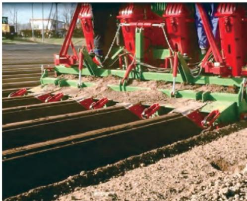
植付された直後に畦立作業が開始されます。覆土ディスクにより土が寄せられて、リッジングフードで培土されます。リッジングフードの接地圧は、油圧ゲージを見ながら調整が可能です。設定した圧力は、アキュムレーターにより保持されます。
