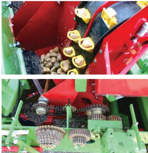
植付される種イモは、大容量ホッパーから4つのプランティングユニットへ供給されます。車輪から得た動力により、カップを備えたゴム製エレベーターが駆動し、種イモを拾い上げます。プランティングユニット内部には、エレベーターに振動を与える機構もあり、カップが2個以上の種イモを拾い上げた場合でも、余分な種イモはこの振動で振り落とされ、1個ずつ植付します。プランティングユニットは簡単な操作で1畦ずつ停止させることが可能です。株間は、工具を用いずに変更することができ、8~47.5cmの範囲で32段階に調整可能です。
