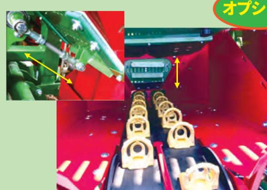
ボトムにも機械駆動式バイブレーターを備えることができます。この部分に振動を加えることで、プランティングユニットの直前で種イモがブリッジすることを予防します。特に切った種イモで植付する際に、ブリッジの発生を最小限に抑えます。
