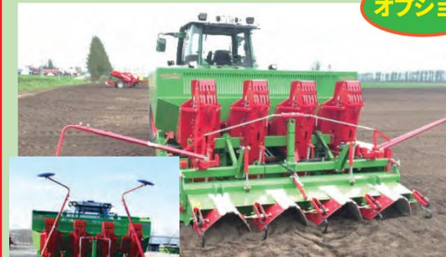
複動油圧1系統で操作するセンターマーカです。移動時には上向きに固定することができます。
