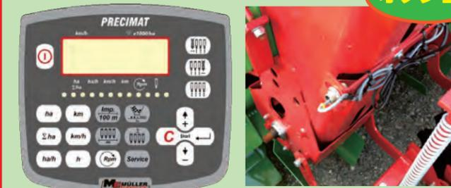
プランティングユニットに装備された植付部監視センサーと、駆動タイヤに搭載された車速センサーを用いて、種イモの欠株が続いた場合に警告を発します。プランティング・ユニットの監視を機械に任せることで、ワンマン作業をサポートします。
