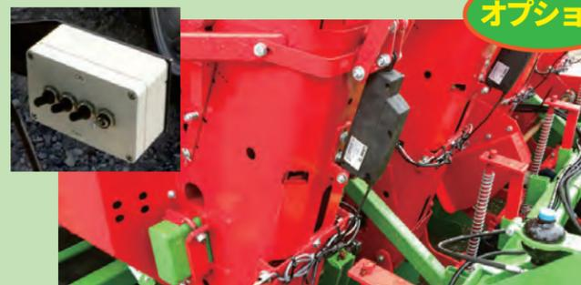
通常は手動で行なうプランティングユニットの停止操作を、電動モーターに置き換えるオプションです。スイッチボックスにより1畦ずつON/OFFができます。油圧式トラックワイパーと組み合わせれば、防除通路を作りながらの植付を準備する際も、トラクターから降りずに行なうことができます。
