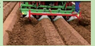
防除通路を作る際には、通路となる両端の植付部を停止し、立てた畦を平にならしながら作業を行います。立てた畦を消す装備：トラック・ワイパーには手動式と油圧式のどちらかを選択可能です。手動式の場合は、畦消しの部品を移設することで、4畦のどの畦にも使えます。油圧式の場合は両側の2畦に作用させます。
