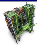
航空力学を応用した軽量で頑強なブームデザイン。ブーム先端部にはノズルガードを装備し、ノズルを保護します。
