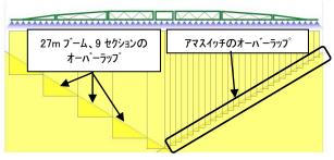
ノズル 1 個ずつ(50cm 間隔)でセクションコントロール可能です。例えば、27m ブーム 9 セクション(6-6-6-6-6-6-6-6-6)と比較した場合、オーバーラップは約 83%抑えられます。 圃場の大きさに関わらず、面積に比例してオーバーラップを最小減にしますので、経費削減につながります。また、馬鈴薯やビートなど、防除費用が高い作物を栽培する際、特に経費削減効果があります。 ※仕様選択
