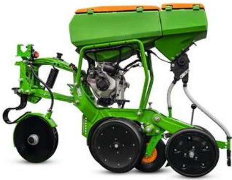
PreTec プレシジョンコーラターは精密播種に最適です。均一な株間、及び、播種深さによって生育を揃え、安定した収量を期待できます。プレセアは、作業速度 15km/h まで対応しており、高い作業能率を実現します。
