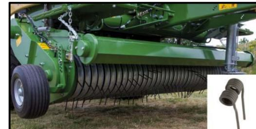
COMPRIMAのピックアップには、振り子機能が備わっています。凸凹な圃場にも的確に対応し、拾いこぼしを軽減します。イージーフローはカムレストラックを採用しています。可動部品が少ないことにより、消耗品が少なくメンテナンスコストを低減します。厚さ6mmで直径が大きなコイルのタイヤは、丈夫で耐摩耗性に優れています。
