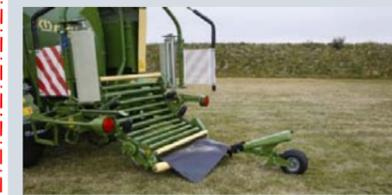
縦おろし装置は、テーブルからの排出時にベールを傾けますので、傾斜地等での転がりを防止します。
