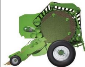
ユニークなセミバリアブルチャンバーの鍵となるのは、テンションロッカーとスプリングサポートです。通常コンベアは上部に張り出しています。作物が入るとコンベアが下がり、これによりベールサイズを可変します。
