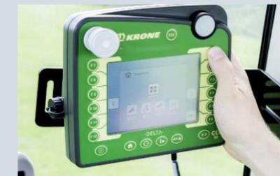
Deltaコントローラーは5.5インチのタッチディスプレイと12個のキーパッド、コントロールダイヤルを備えた視認性のよい使いやすい操作端末です。
