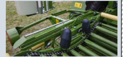
ベール排出時フィルムカッターはフィルムを切断し、ラッピング作業開始時はフィルムを確実に保持します。
