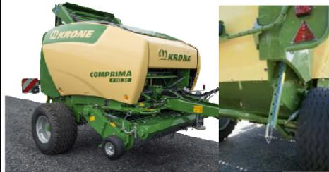
セミバリアブルチャンバー方式を採用したF155のベールサイズ調整は、機体後部のピンを差し替えることで行います。
