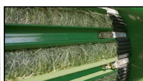
クローネラウンドベラー最大の特徴といえるのがコンベアを使用した特別なデザインの梱包システムです。ノボグリッパベルトは、耐久性に優れた3層構造のゴムベルトです。梯子状に配置されたスラットバーは、ベールに対してしっかりとグリッパし、確実にベールを回転します。このシステムは様々な困難な条件でも柔軟に適応します。
